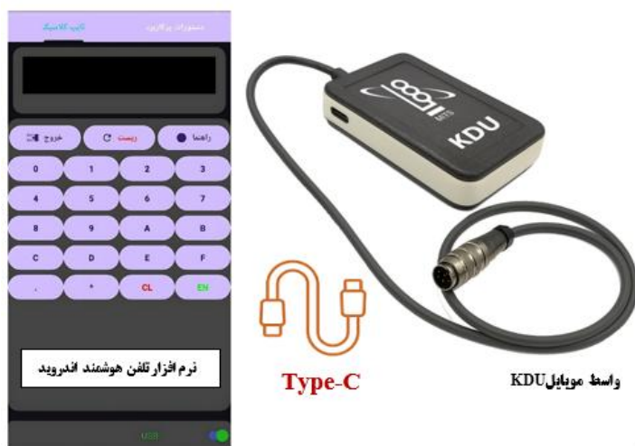
شکل ۱۴-۲ نمونه واسطه تست و خطایاب KDU همراه
