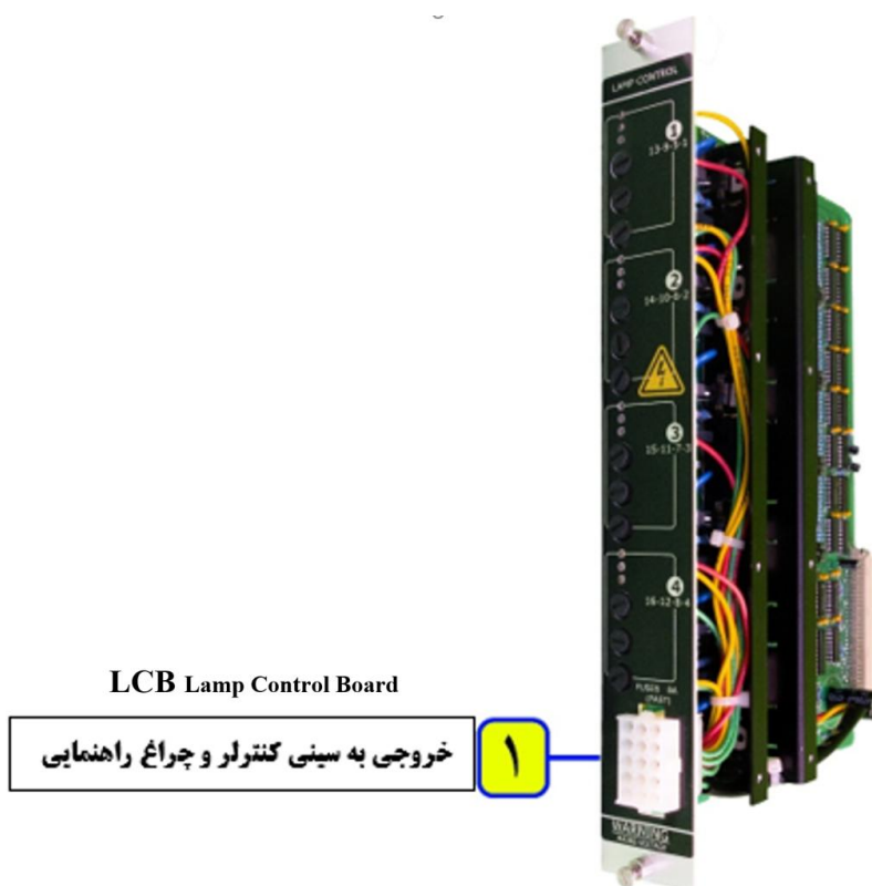
شکل ۸-۲ برد خروجی کنترلر به چراغهای راهنمایی LCB
