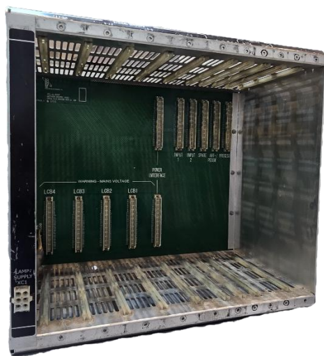
شکل ۹-۲ بدنه آلومینیومی و برد اصلی پشت آن
